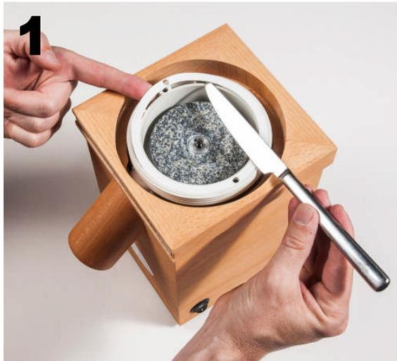
Nun den unteren Stein festhalten und die Schraube in der Steinmitte mit dem mitgelieferten Inbusschlüssel im Uhrzeigersinn aufdrehen. Anschließend mit dem beiliegenden Kabel den Stein an der Unterseite packen und gleichmäßig nach oben ziehen – Bild 2. Bei Bedarf Mahlkammer und Auslauf mit beiliegender Bürste reinigen – Bild 3.
